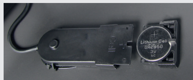
Batterie ist wechselbar. Dadurch erhöhte Langlebigkeit des Helms.
